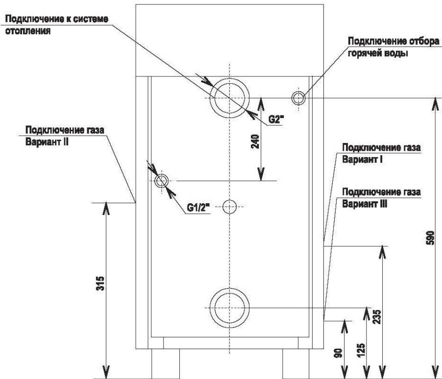
Рис. 7.3 Схема подключения котлов
