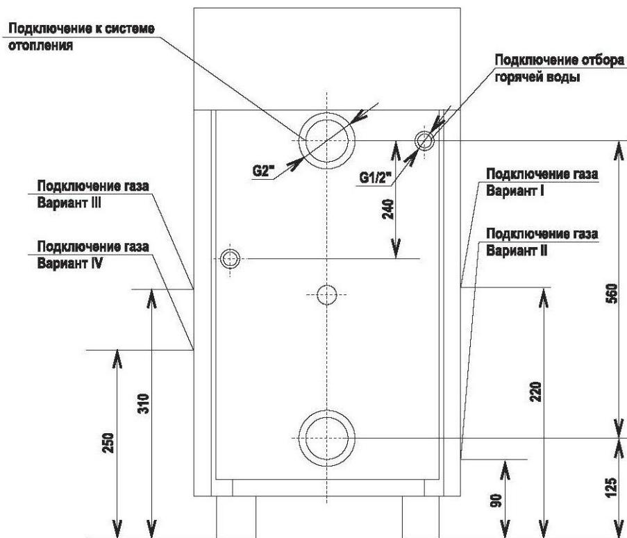
Рис. 7.4 Схема подключения котлов
